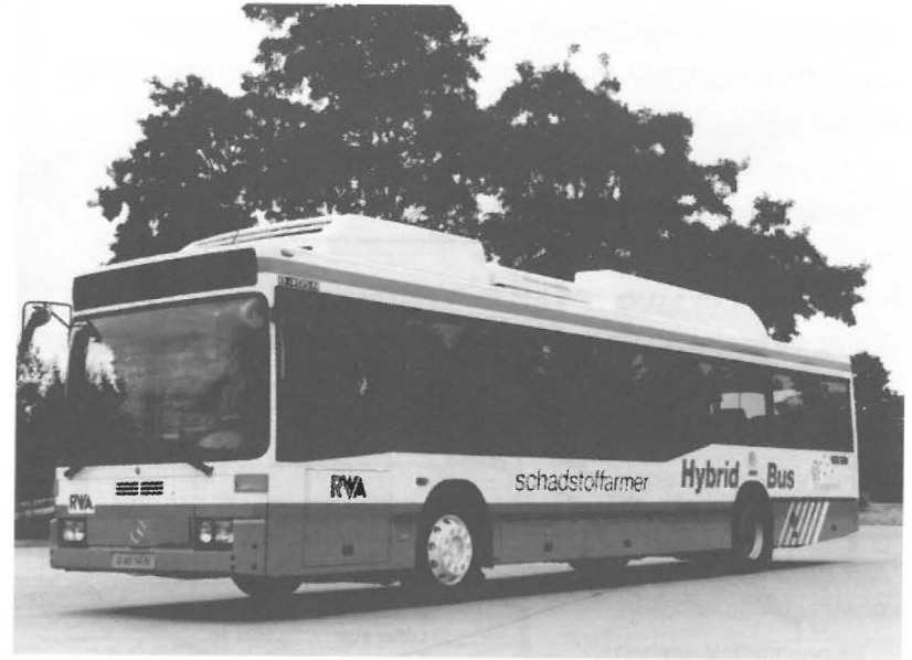
Bild 5: Hybridbusse (Dieselmotor 185 kW , 2 Radnabenmotoren, ZEBRA-Batterien)
